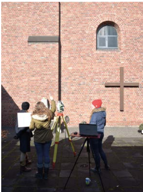
Abb. 83: Tachymetergestützte Bauaufnahme im Innenhof der Kirche
